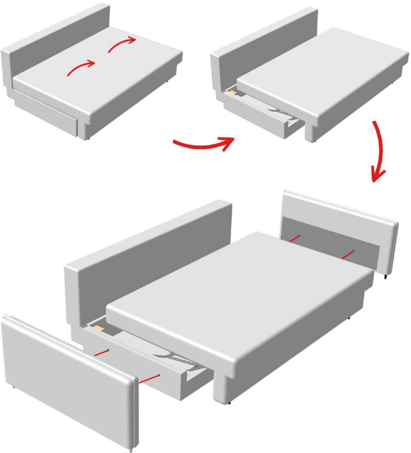
Установить подлокотники на каркас диванной секции согласно схеме: сидушку требуется перевести на половину хода подъемного механизма (сидушка находится в “приподнятом” состоянии). Далее установить левый и правый подлокотник с помощью болтов M8 и шайб 8.
