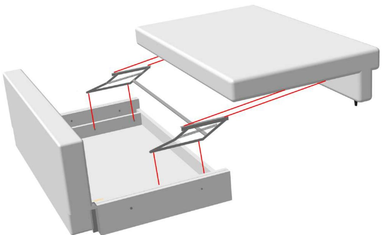
Собрать секцию согласно схеме: прикрутить подъемный механизм к основанию диванной секции, далее прикрутить сидушку диванной секции к подъемному механизму
