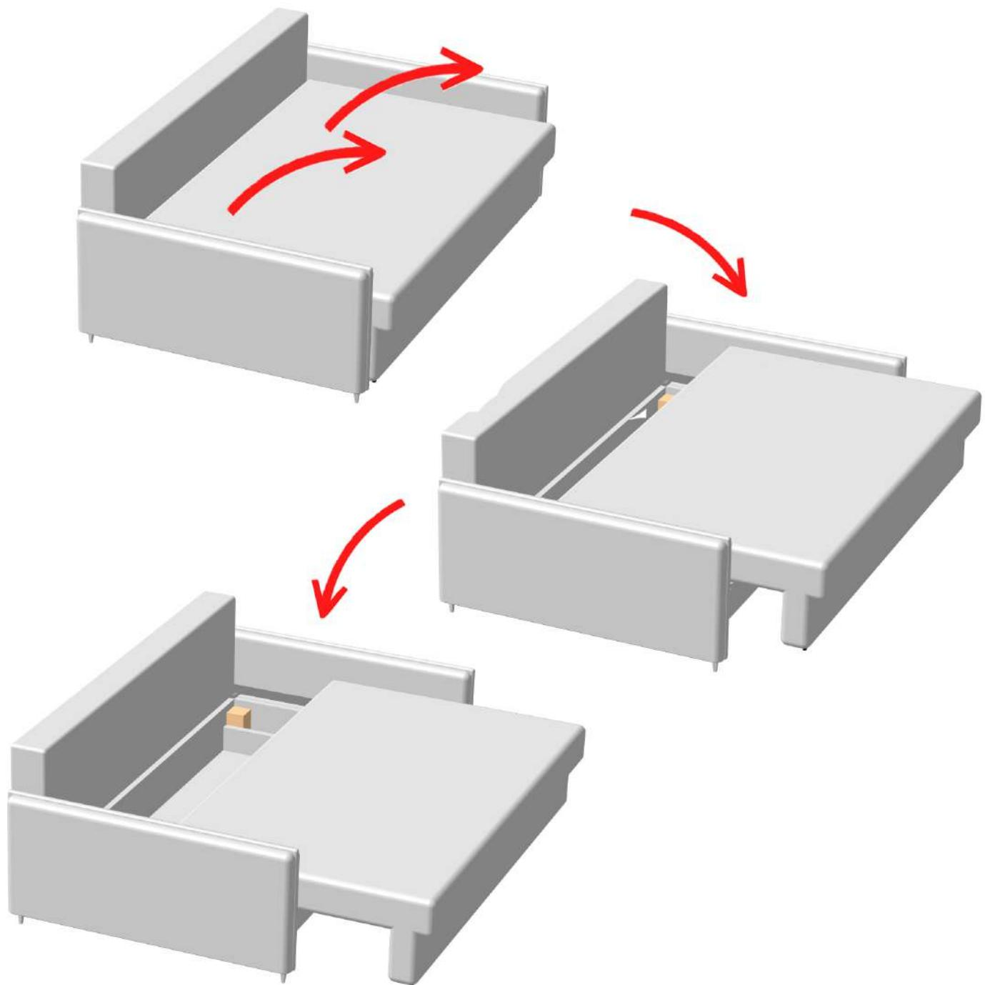
Трансформация дивана осуществляется путем поднятия сидушки по дугообразной траектории. Механизм компенсирует часть подъемной нагрузки и задает верную траекторию движения.
