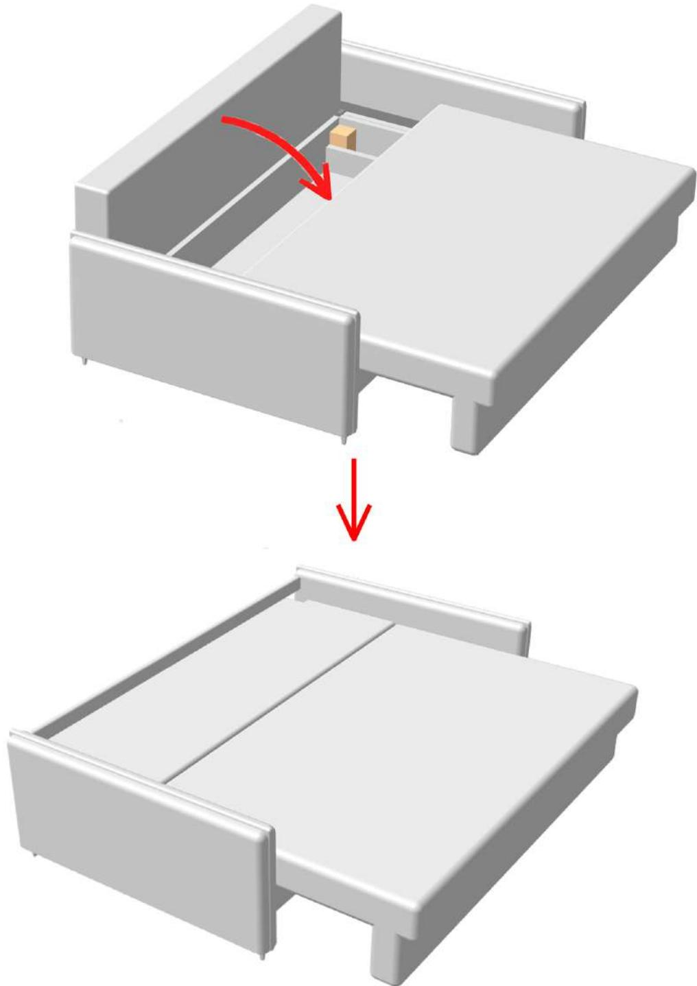
После трансформации седушки диванной секции требуется перевести спинку в горизонтальное положение, путем опрокидывания на 90 градусов.
